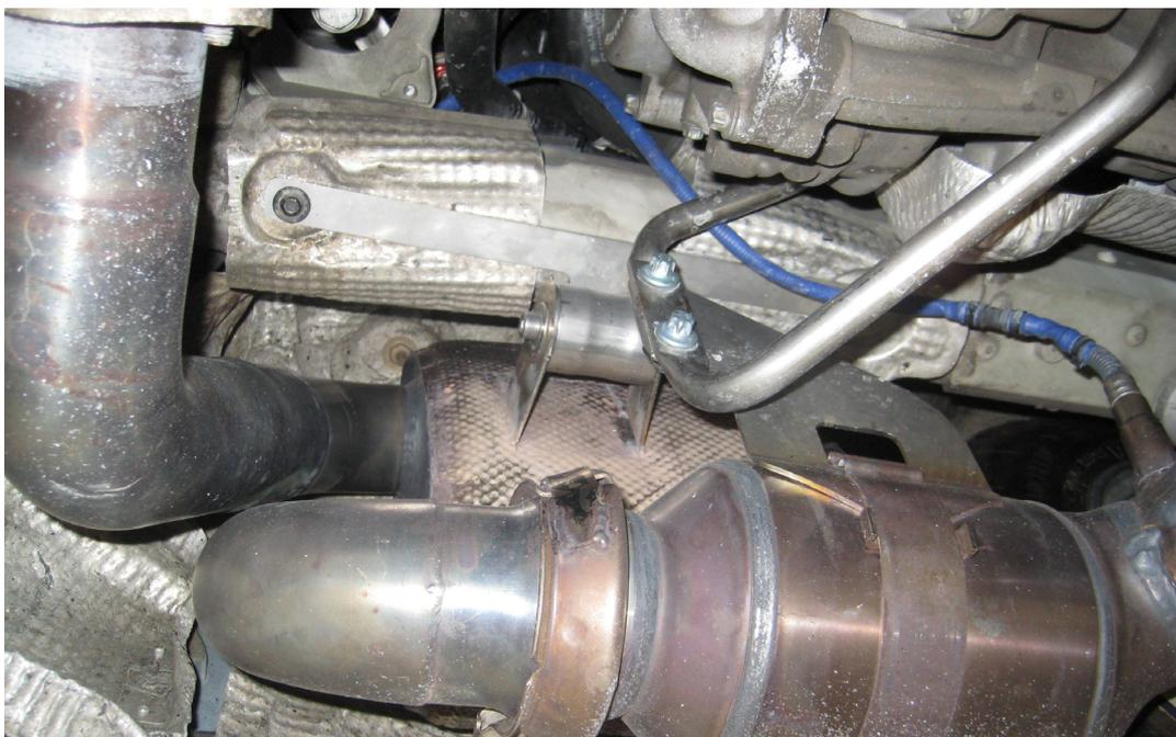
Zusätzlich sind die Seitenschalldämpfer mit einer Serviceöffnung ausgestattet, über die ein Nachstopfen möglich ist.
